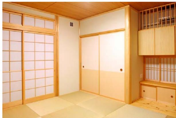
リビングの隣になる和室は縁のない琉球畳。左の障子の上にある欄間窓は、家の中に風を通り抜けさせるのに効果的。押入れ右手にも障子窓。このように、どの部屋からも2方向の景色が見えるつくりになっている。
